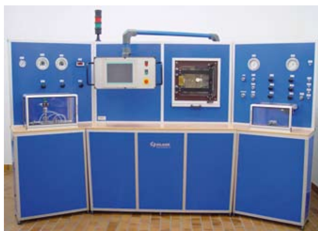
Ventil- und Maskenprüfstand mit Partialdruckmessung. Bildquelle: OLAER (SCHWEIZ) AG
