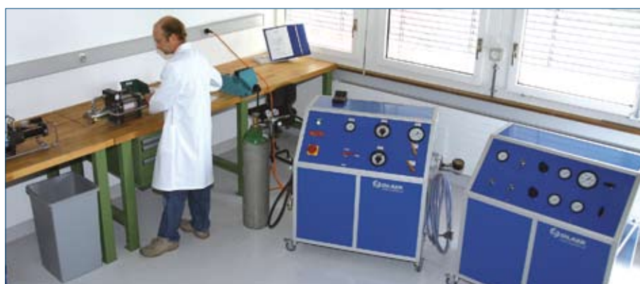
Leistungsstarke Hochdruck-Kompaktsysteme für den Medizinalsektor werden in einem separaten Raum montiert. Bildquelle: OLAER (SCHWEIZ) AG
