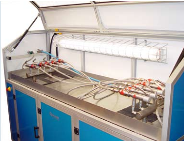
Bis zu fünf Hochdruckschläuche können auf der neuen Anlage gleichzeitig geprüft werden. Sie arbeitet damit fünf mal schneller als es vorher möglich war. Bildquelle: OLAER (SCHWEIZ) AG
