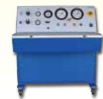
Banc d'essai à impulsion (2500 bar) permettant de déterminer la durée de vie de capteurs de proximité.
