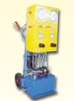
Installation de surpression mobile à 3000 bar, utilisée pour séparer/extraire du matériel ferroviaire roulant.
