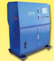
Installation de surpression 1200 bar pour le calibrage des transmetteurs de pression.
