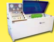
Station de transvasement d'oxygène médical et de remplissage de bouteilles d'oxygène utilisées dans les avions.
