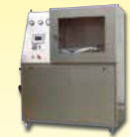
Banc d'essai d'éclatement pour tuyaux d'incendie de 0 à 50 bar.
